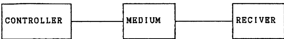
รูปที่ 2.2 แสดงหลักการเบื้องต้นของรีโมตคอนโทรล
