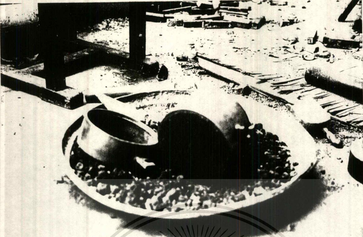
รูปที่ 3.3 ข. แสดง Mold ที่ดินที่ถูก Compact. เมื่อกอด Collar ออกแล้ว
