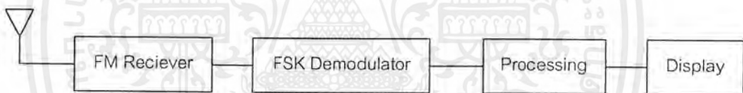
รูปที่ 3.5 บล็อกไดอะแกรมของภากรับข้อมูลและแสดงผล
