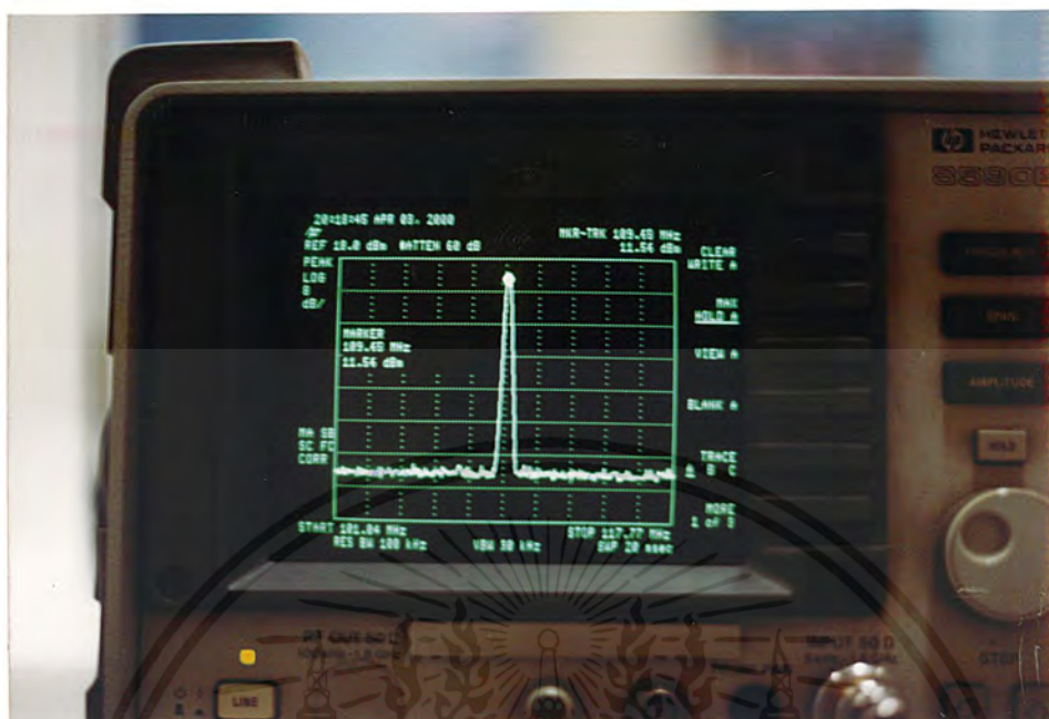
รูปที่ 4.3 แสดงกำลังงานของเครื่องส่งที่ทำการวัดเท่ากับ 11.54 dBm
