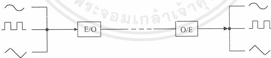
รูปที่ 1.1 หลักการส่งสัญญาณชนิดต่างๆ ผ่านเส้นใยแก้วนำแสง
