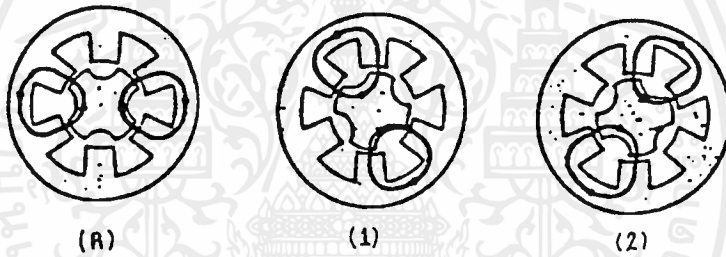
รูปที่ 2.6.9 เส้นแรงแม่เหล็กเมื่อขับแบบ 2 เฟส
