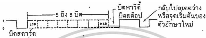
รูปที่ 2.6 รูปแบบของการสื่อสารแบบอะซิงโครนัส
