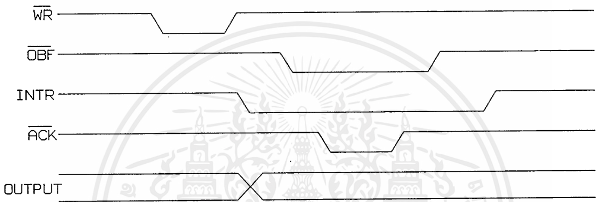
รูปที่ 13 แสดงถึงลำดับสัญญาณที่ 8255 ส่งข้อมูลออกมาเพื่อให้อุปกรณ์ภายนอกอ่านข้อมูลไป
