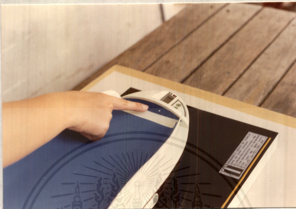
ภาพที่ 5.3.7 แสดงส่วนปราชเท้าซิกเป็นจุดเริ่มต้นเป็นศูนย์ในการวัดความยาว ลำตัวทารก
