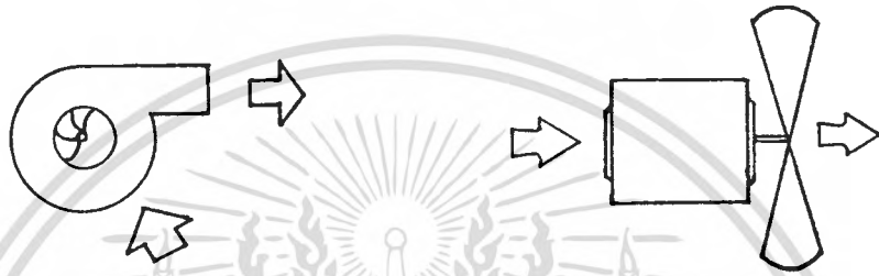
รูปที่ 4.8 ประเภทของใบพัดลมแบบต่าง ๆ
