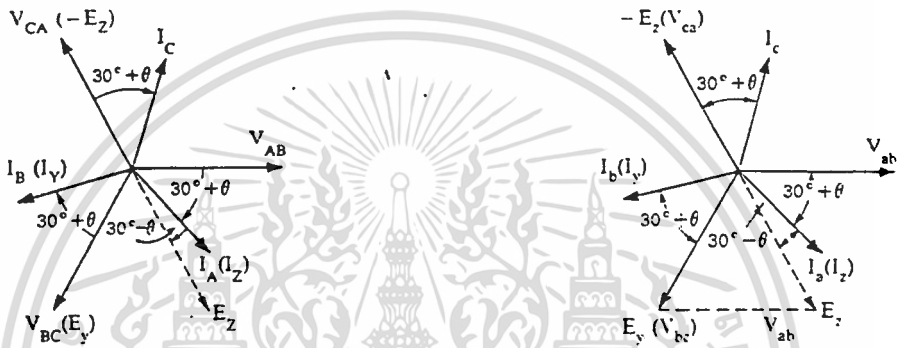
รูป 18 แผนภาพเวกเตอร์ของการต่อแบบ V
