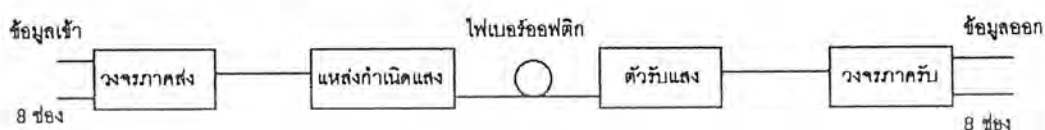
รูปที่ 2.32 แสดงตัวอย่างของระบบของการสื่อสารด้วยเส้นใยแสง
