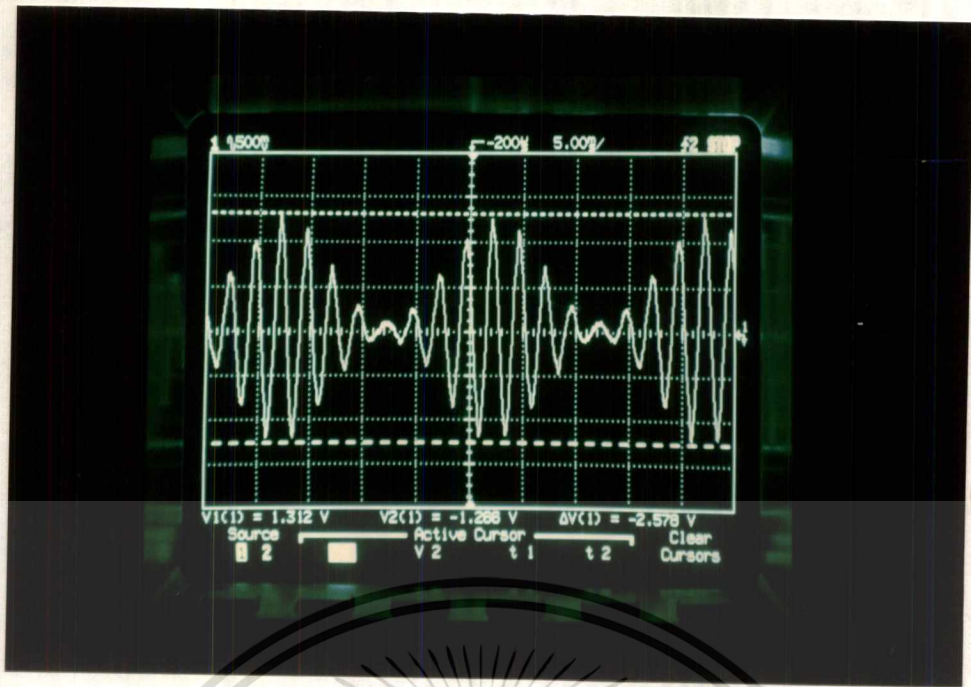
รูปที่ 4.8 แสดงสัญญาณ Dial Tone ที่วัดได้ที่ขา Collector ของ Q25
