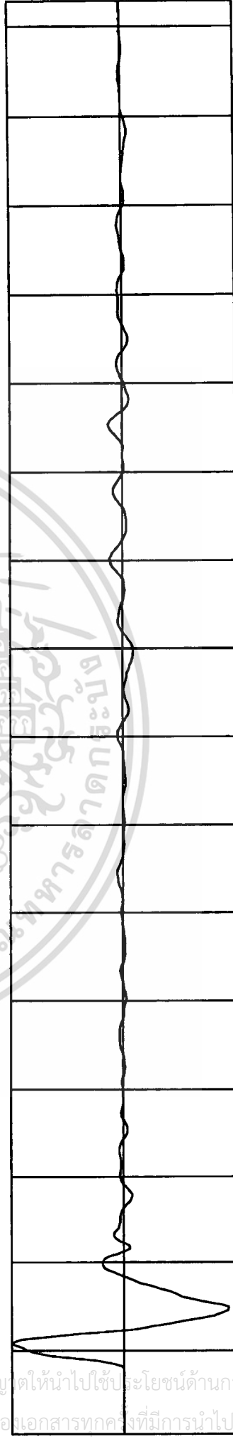
รูปที่ 6.36 คลื่นสัญญาณแสดงลักษณะเสาเข็มที่มีความสมบูรณ์ และสามารถสังเกตความถี่ของไม่พบสัญญาณที่ปลายเสาเข็ม
