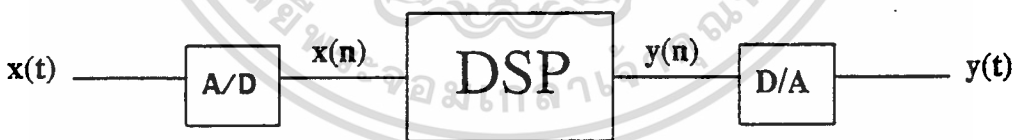
รูปที่ 1.3 การเปลี่ยนไปมาระหว่าง analog signal กับ digital signal
