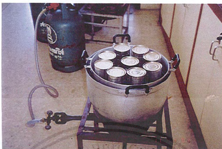
รูปที่ 5 ขั้นตอนการนึ่งมาเชื้อผลิตภัณฑ์สับปรดบรจกระป๋อง
