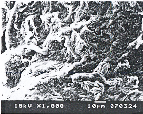
รูปที่ 4.32 ลักษณะพื้นผิวของวัสดุพอลิโพลิฟีนส์ผสมสาหร่าย Gracilaria fisheri หลังถูกย่อยสลายโดยเชื้อจุลินทรีย์ในน้ำ ระยะเวลา 10 วัน กำลังขยาย 1.000 เท่า
