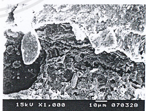
รูปที่ 4.37 ลักษณะพื้นผิวของวัสดุพอลิโพลิฟีนส์ผสมสาหร่าย Gracilaria fisheri หลังถูกย่อยสลายโดยเชื้อจุลินทรีย์ในน้ำ ระยะเวลา 60 วัน กำลังขยาย 1.000 เท่า
