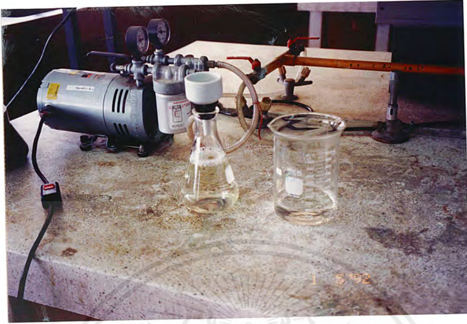
รูปที่ 5 : น้ำทิ้งโรงงานแปรรูปไก่ก่อนกรอง และหลังกรอง
