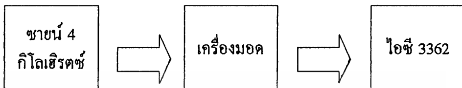
รูปที่ 5.8 แสดงขั้นตอนการคีมอด โดยใช้ไอซี 3362
