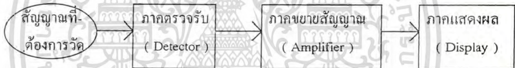
รูปที่ 1.1 แสดงบล็อกไดอะแกรม(Block Diagram)ของเครื่องมือวัดคลื่นไฟฟ้าหัวใจ
