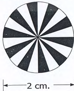
รูปที่ 3.1 การออกแบบแผ่นเพลทเซนเซอร์ขนาด 20 ส่วน
