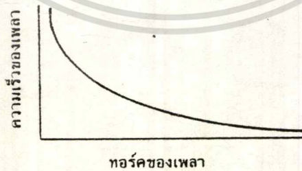
รูป 3.5 คุณสมบัติระหว่างความเร็วและแรงบิดของดีซีมอเตอร์อนุกรมภายใต้ภาวะโวลท์ที่คงที่
