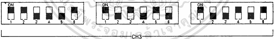
รูปที่ 7.4 การเลือกหัวสายช่องสัญญาณที่ 3
