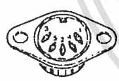
คอนเนคเตอร์สำหรับ คีย์บอร์ดแบบ DIN (5 ขา)
