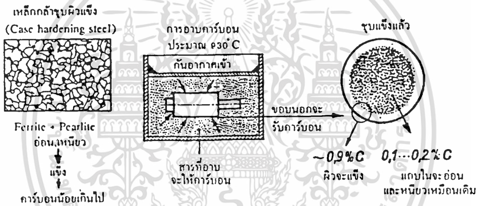
รูปที่ 1. การอบคาร์บอนเหล็กกล้าที่มีคาร์บอนระหว่าง 0.1...0.2%
