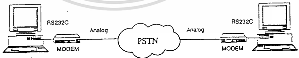
รูปที่ 3.2 โมเด็มช่วยให้คอมพิวเตอร์รับส่งข้อมูลผ่านสายโทรศัพท์ได้โดยเปลี่ยนสัญญาณให้เป็นเสียงก่อน
