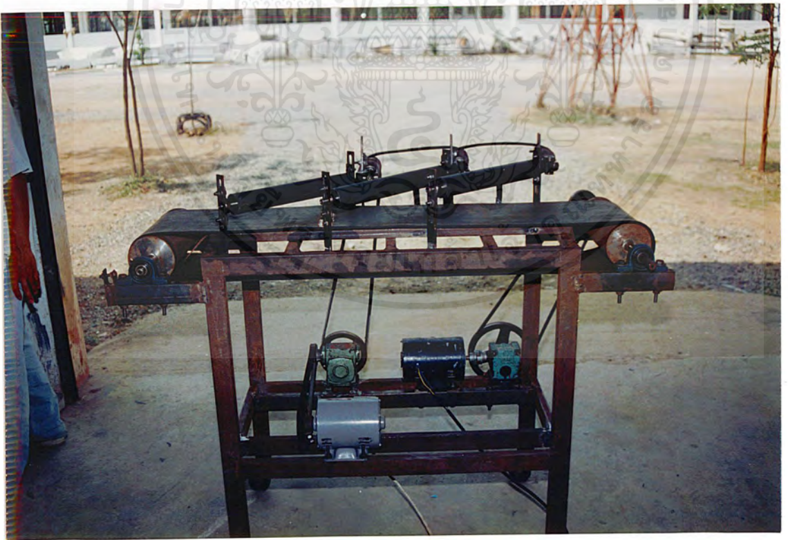
รูปที่ 4.9 เครื่องัดขนาดมั่งคุดแบบลูกกลิ้งัดขนาด
