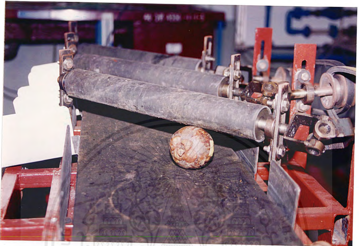
รูปที่ 5.8 ลักษณะการคัต้มังคุดของเครื่องในขณะทำการคัค
