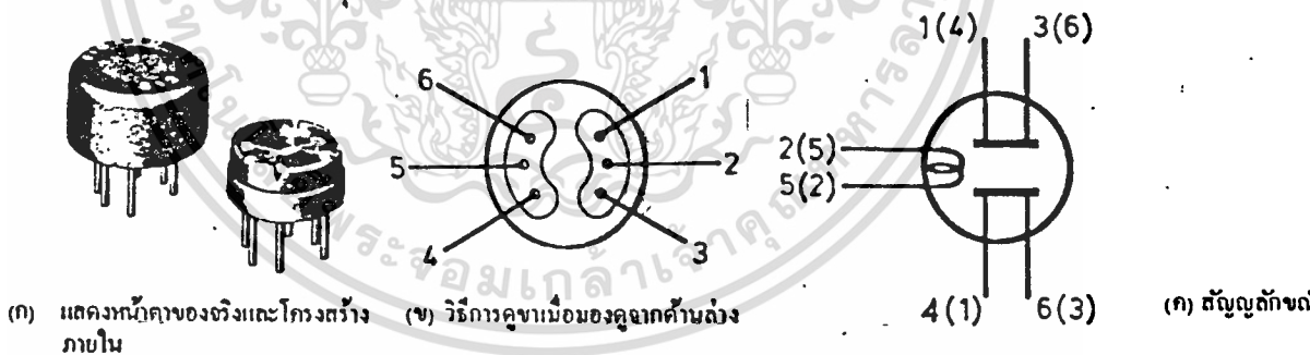
รูปที่ 3.2 ตัวดักจับก๊าซ TGS รุ่น 812 และ 813
