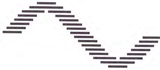
รูปที่ 21 แสดงรูปสัญญาณที่ออกจากวงจร Walsh function
