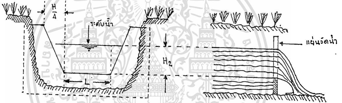
รูปที่ 8 การวัดปริมาณน้ำผ่านฝายรูปสี่เหลี่ยมคางหมู
