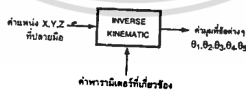
รูปที่ 6 บล็อกไดอะแกรมของสมการ inverse kinematic
