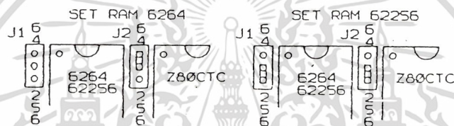
รูปที่ 4.3 แสดงการ Jump (J2) ตำแหน่งเพื่อเลือกเบอร์ RAM
