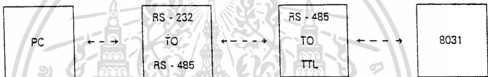
รูปที่ 3.16 แสดง Block Diagram ของ RS-232<-> RS-485 และ RS-485 <-> TTL
