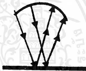
ภาพประกอบที่ 2.61 เสียงสะท้อนผนังผิวโค้ง
