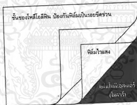
รูปที่ 2.12 โครงสร้างของแผ่นทรายฟิล์ม
