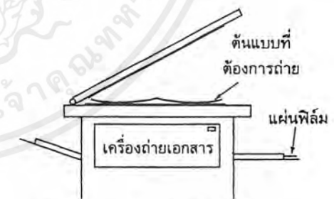
(ข) นำไปถ่ายลงแผ่นฟิล์มด้วยเครื่องถ่ายเอกสาร
