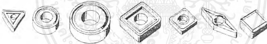
รูปที่ 2.19 อินเดิร์ทแบบถอดเปลี่ยนได้รูปทรงต่างๆ
