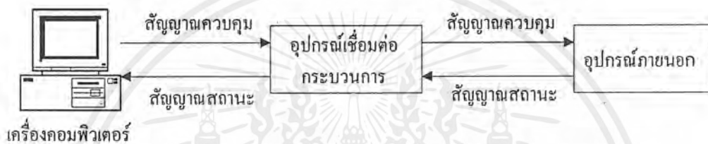
รูปที่ 5.1 แสดงการนำการสื่อสารแบบอนุกรมไปประยุกต์ใช้งานในระบบควบคุม
