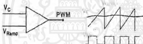
รูปที่ 2.35 แสดงลักษณะการทำงานของวงจร PWM
