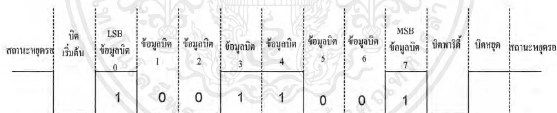
รูปที่ 2.1 รูปแบบของข้อมูลอนุกรมแบบอะซิงโครนัส
