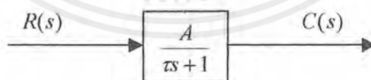
รูปที่ 2.6 แผนภาพบล็อกของระบบอันดับหนึ่ง
