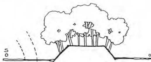
รูปที่ 14 การป้องกันเสียงจากภายนอกโดยการใช้เนินดินประกอบกับต้นไม้
