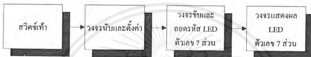
รูปที่ 3.1 บล็อกไดอะแกรมของวงจรเครื่องนับการขับเคลื่อนหลัก
