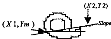
รูปที่ 13 การหาความชันจากจุดอ้างอิง เมื่อได้ระดับ Ym ซึ่งเป็นตำแหน่งในการอ้างอิงของการหาความชัน ส่วนของพิกัด (X1,Ym) เป็นจุดอ้างอิงแรกในการหาค่าความชัน จุดที่ใช้เปรียบเทียบ
