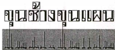
รูปที่ 3 ผลของการหาค่า Peak to valley ของตัวอักษรไทย
