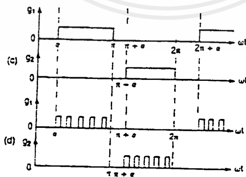
รูปที่ 3.4.3 วงจรควบคุมหนึ่งเฟส แบบ เต็มคลื่น กับ โหลด RL (Single-phase full-wave controller with RL load)
