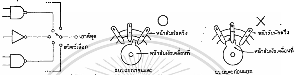
รูปที่ 2.26 สวิทช์เลือกที่ไว้กันเอาต์พุตของไอซี
