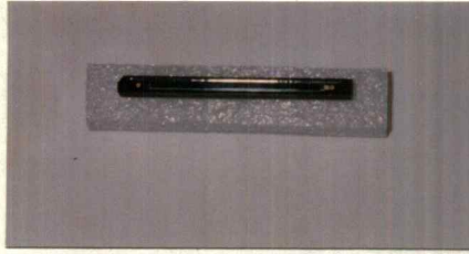
รูปที่ 4.13(ข) ลักษณะของหน่วยย่อยในตัวรับรังสีเอ็กซ์แบบสารกึ่งตัวนำ
