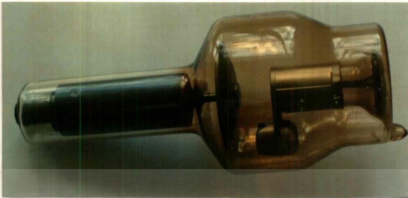
รูปที่ 4.11 ลักษณะของตัวหลอดรังสีเอกซ์แบบอาโนดหมุน
