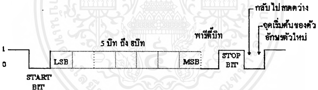
รูป 4.4 ฟอ์แมตการสื่อสารแบบอะซิงโครนัส
