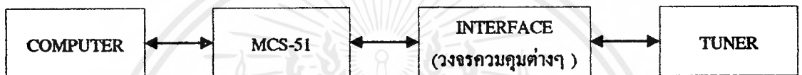
รูปที่ 6.5 แสดงบล็อกโคโอะแกรมการควบคุมภาครับวิทยุ FM STEREO
