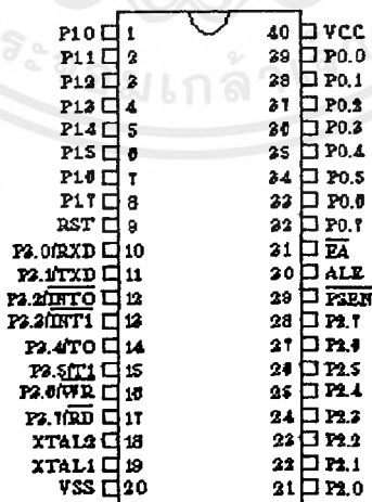
รูปที่ 2.5 ไดอะแกรมขาของ 8051 แบบ DIP
