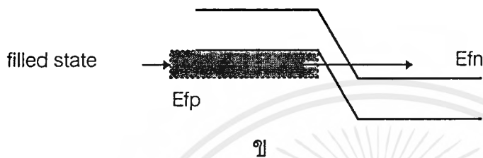
รูปที่ 4.5 ข แสดงโครงสร้างแถบพลังงานของแบบเวรีดไดโอดชนิดที่ไม่มีความต้านทานเชิงลบ เมื่อให้ไบอัสย้อนกลับ
