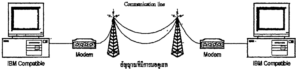
รูปที่ 2.2 แสดงลักษณะการส่งสัญญาณผ่าน โมเด็ม
